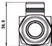
插头除键槽及类型标识不同外，其它结构均相同
